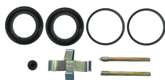
9 GM 99 Reparo de pinça (compl.)
